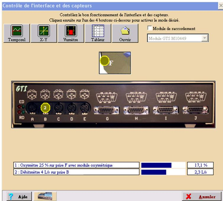
Une fenêtre s'ouvre alors avec la façade de l'interface et les branchements à effectuer. Vérifiez vos branchements :
